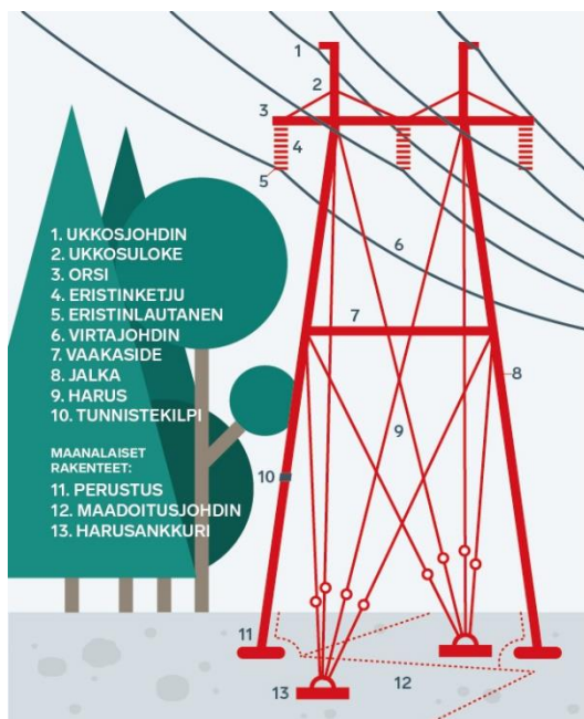
Kuva 5-7. Voimajohdon osat (Fingrid 2020).
